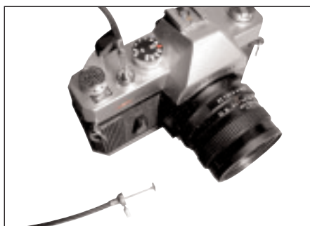
Abb. 73: Eine analoge Spiegelreflexkamera mit Drahtauslöser
