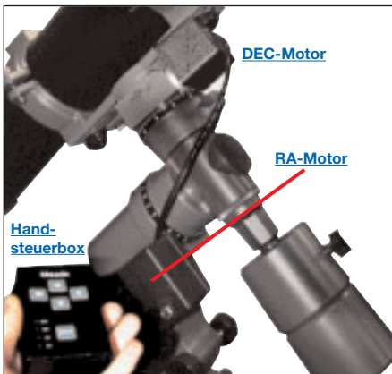
Abb. 65: Ein parallaktisch montiertes Teleskop mit nachgerüsteten Motoren
