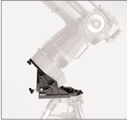
Abb. 79: Dieses Teleskop mit azimuthaler Gabelmontierung ist auf einer Polhöhenwiege montiert
