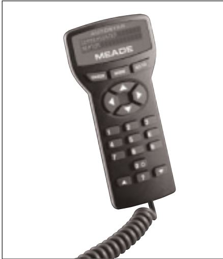
Abb. 77: Ein bekanntes Go-To-System ist der Meade AutoStar #497. Er verwandelt das (speziell vorbereitete) Teleskop in eine Heimsternwarte.
